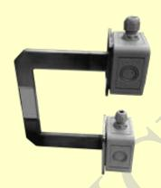
Принцип действия влагомеров основан на измерении величины поглощения СВЧ энергии влажным материалом и преобразовании этой цифровой величины В код, соответствующий влажности материала. Чрезвычайно высокая контрастность метода ( 1 см воды уменьшает мощность прошедшей радиоволны В 10000 раз позволяет измерять влажность как высокой плотного зерна C
