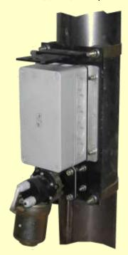
задвижкой, при помощи которой перекрывается доступ зерна в измерительное пространство при диагностике и обслуживании датчика.
