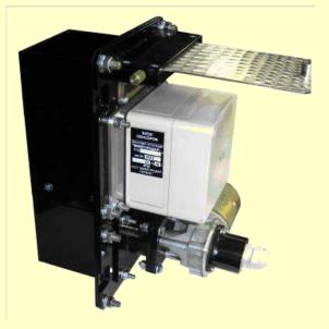
Датчик крепится на стенке бункера или самотека в подготовленном отверстии таким образом, чтобы падающее зерно попадало в наполнительный короб. Верхняя часть короба оборудована
