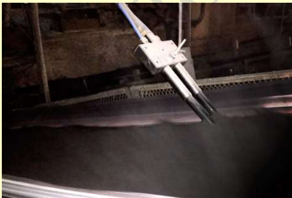
Рис.2. Монтаж датчика влагомера на конвейерной ленте с железорудным концентратом на Северном ГОКе, г. Кривой Рог. Испытания в промышленных условиях проводились в.2019 - 2020 гг.
