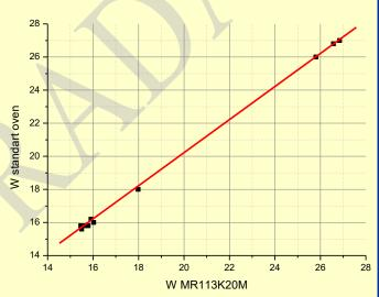
Установка MP113К20M на маслоизготовителе MC9 SIMON FRERES. Диапазон влажности 15-27%, среднеквадратическое отклонение 0,21%.
