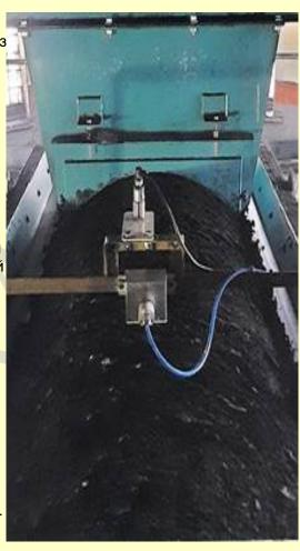
НПО МИКРОРАДАР предлагает серию поточных микроволновых анализаторов влаги в угле для всех технологических переделов при обогащении.
